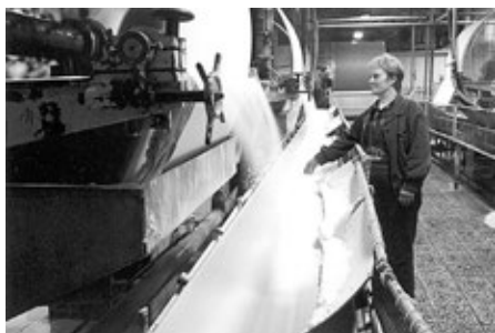
Na specjalnych bębnach oddzielano uzyskany krochmal od wody fot. Przemysław Maćkowiak
