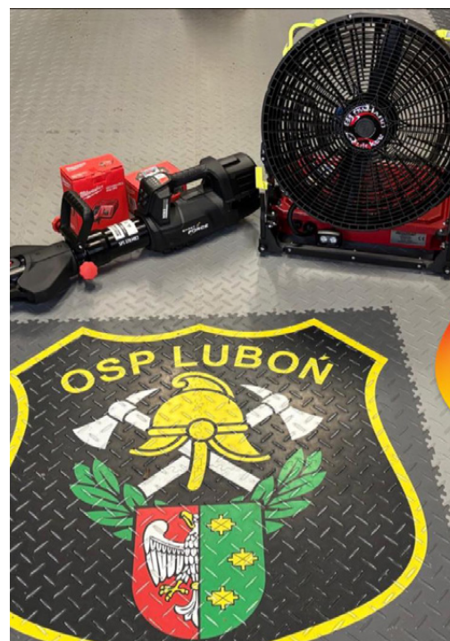
Urządzenia ratownicze: elektryczny wentylator oddymiający oraz nożyco-rozpieracz akumulatorowy wraz z akcesoriami fot. Zb. OSP Luboń
