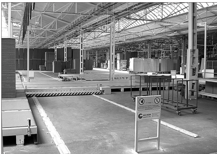
Ryc. 16. Krzycko Wiel- kie – Werner Kenkel Za- kład Produkcji Tektury Falistej i Opakowań – pośrodku prze- suwnica sta- nowiąca część automatyczne- go transportu wewnętrznego (2009 r.)
