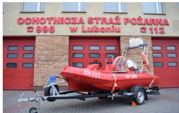
Łódź KONTRA 400RC o silniku HONDA 30KM (wymiary: dł. 4 m, szer. 1,6 m, wys. 0,79 m, waga: 153 kg) fot. Maciej Splisgart
