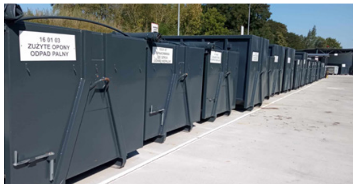
Kontenery hakowe do selektywnej zbiórki odpadów PSZOK fot. Beata Spychała
