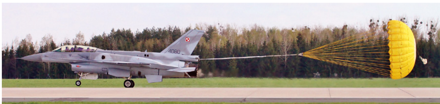
Wielozadaniowy myśliwiec Lockheed Martin F-16D Block52+ Jastrząb w wariantcie dwumiejscowym lądujący z użyciem spadochronu. Po wygraniu przetargu tego typu samoloty służą od 2006 roku w Siłach Powietrznych RP.
