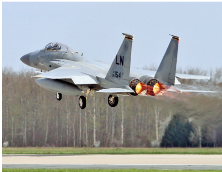
Amerykański dwusilnikowy myśliwiec przewagi powietrznej McDonnell Douglas F-15 Eagle zaczęto produkować w 1973 roku. Jest przeznaczony do walki w każdych warunkach atmosferycznych.
